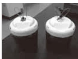
左:図3 作成した微生物燃料電池
